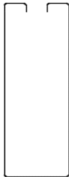
Bild 26 - Beispiel Doppelwandige Lamelle / Baffel aus gekantetem oder rollverformtem Blech
