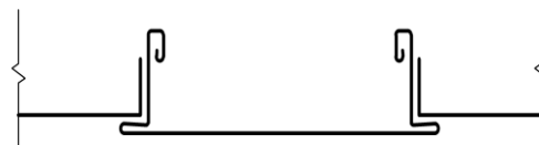
Bild 10 - Beispiel Bandrasterystem mit Auflage-Bandrasterprofil
