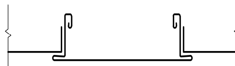
Bild 10 - Beispiel Bandrasterystem mit Auflage-Bandrasterprofil
