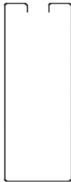
Bild 26 - Beispiel Doppelwandige Lamelle / Baffel aus gekanteten oder rollverformten Blech
