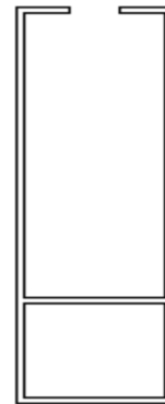
Bild 27 - Beispiel Doppelwandige Lamelle / Baffel aus gepressten Aluminium
