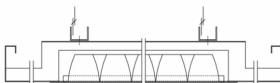
Flursystem      Einhänge- und Haken-Klapp-Schiebesystem
