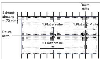
Die erste Platte wird in der Raummitte mit einem Laser oder einer Schlagschnur an der Längsseite ausgerichtet und anschließend an der Unterkonstruktion verschraubt. Auf die nachfolgenden Platten wird vor der Montage der Kleber lückenlos auf der kompletten Kante aufgetragen.
