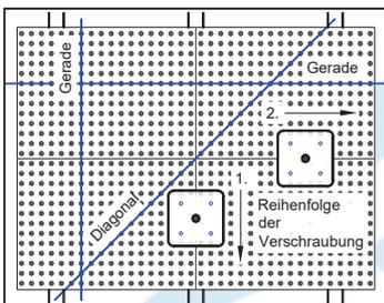
Mittels der zum Lochbild gehörenden Montagehilfe werden die Platten in Angrenzung an die bereits verschraubten Platten montiert. Dabei wird zuerst die Längsseite und danach die Stirnseite verschraubt. Durch das Fluchten der Lochreihen in der Geraden und der Diagonalen wird die Ausrichtung der Platten kontrolliert. Bei größeren Flächen sollte ca. alle 10 Meter eine Dehnungsfuge vorgesehen werden.
